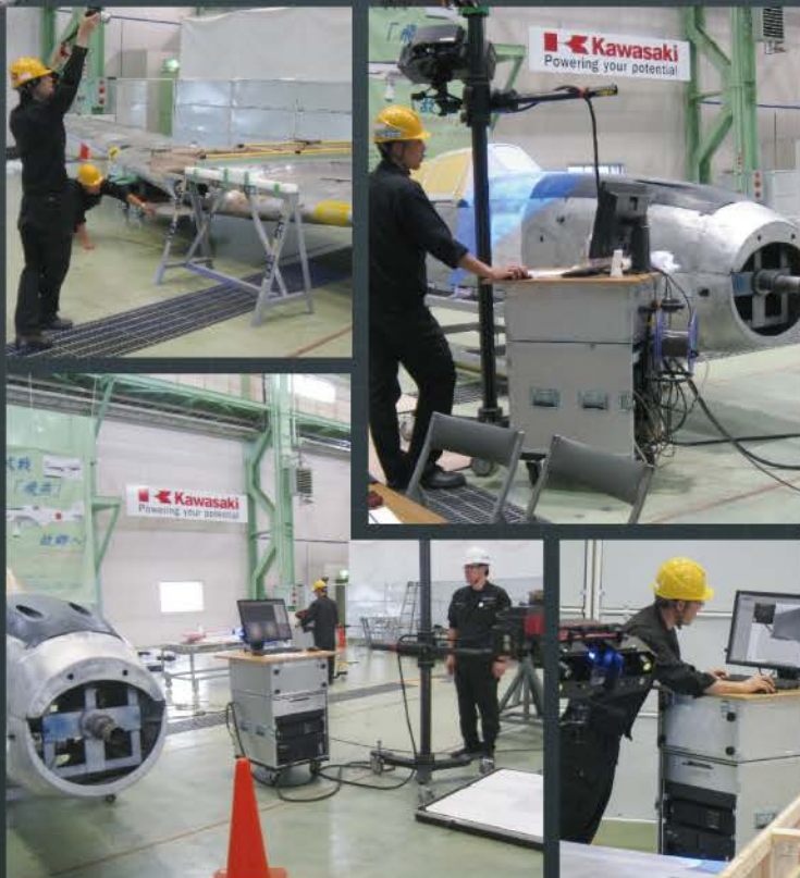
3次元スキャナーで飛燕の機体を計測する原製作所技術者
