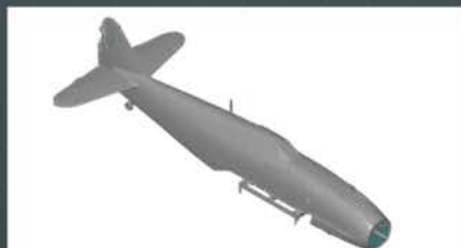
分解された部品単位で高精度に3Dデータ化
