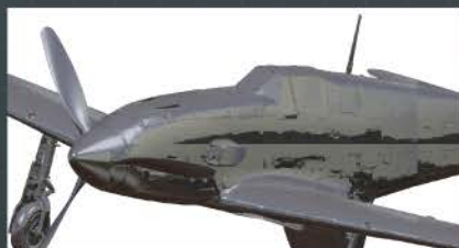
部品単位で計測した3Dデータを合成して機体全体の形状を3Dデータで復元
