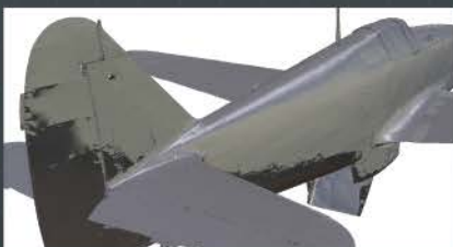
部品単位で計測した3Dデータを合成して機体全体の形状を3Dデータで復元
