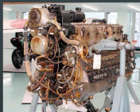
現存する飛燕のエンジン (液冷倒立V型12気筒)
