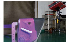
治具を用いたドアパネル樹脂部品の計測
