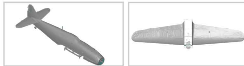
分解された部品単位で高精度に3Dデータ化
