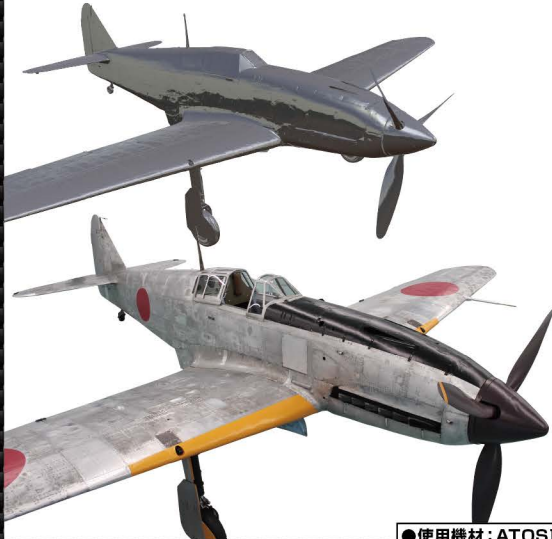
分解された部品単位で高精度に3Dデータ化
