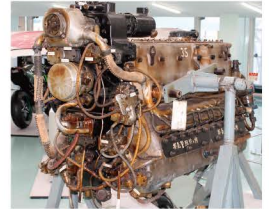
現存する飛燕のエンジン (液冷倒立V型12気筒)
