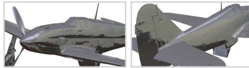
部品単位の3Dデータを合成して機体全体の形状を3Dデータ化
